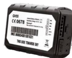
Dispone di accelerometro 3D integrato con motion detection e può essere collegato a un relè per il blocco avviamento e ad una presa di forza per tenere sotto controllo le attrezzature collegate al mezzo. Le sue caratteristiche tecniche principali sono:
